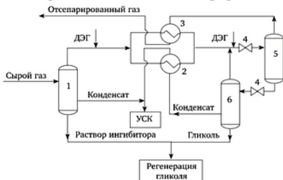
Принципиальная технологическая схема установки низкотемпературной сепарации газа
