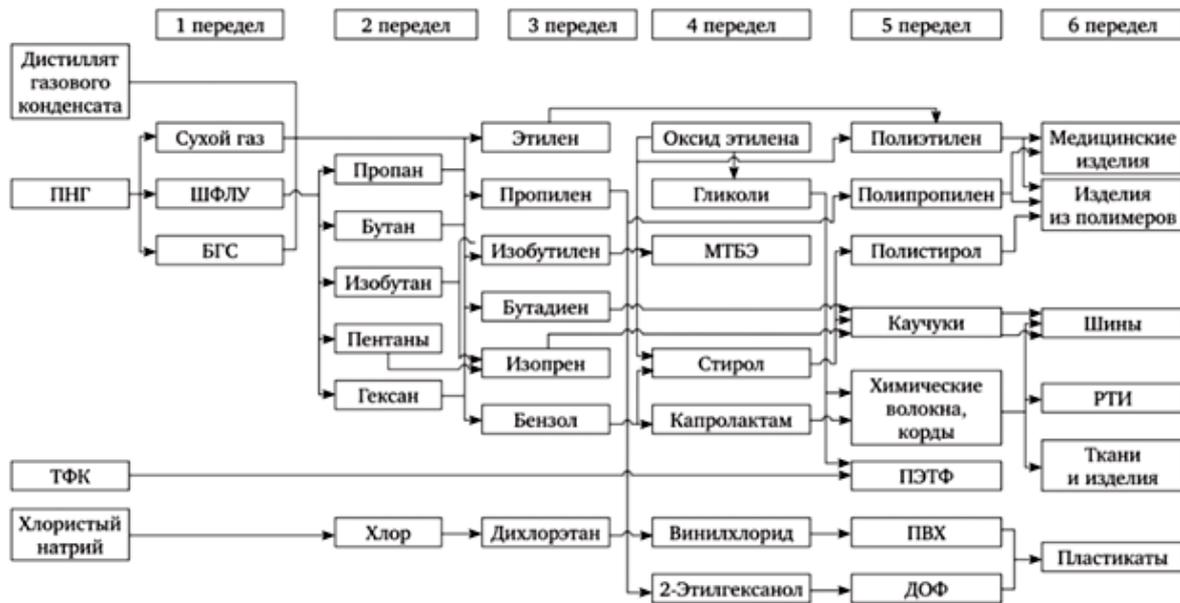
Схема технологического передела сырья производственного блока ПАО «Сибур Холдинг»
